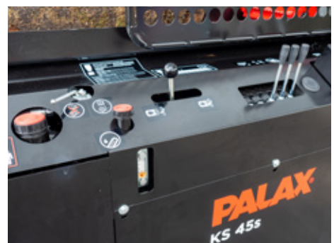
Zentrale Bedienplattform, um eine einfache Bedienung zu ermöglichen.
