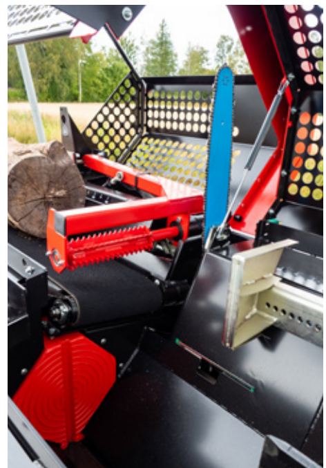
Die Holzklemme mit hydraulischer Antriebsrolle sorgt für eine effiziente Holzzufuhr.
