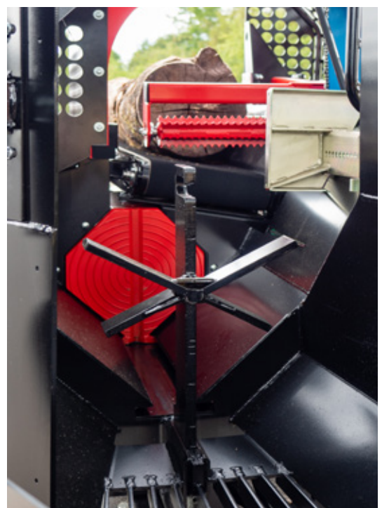
Einfacher Spaltmesserwechsel durch das Schnellwechselsystem.
