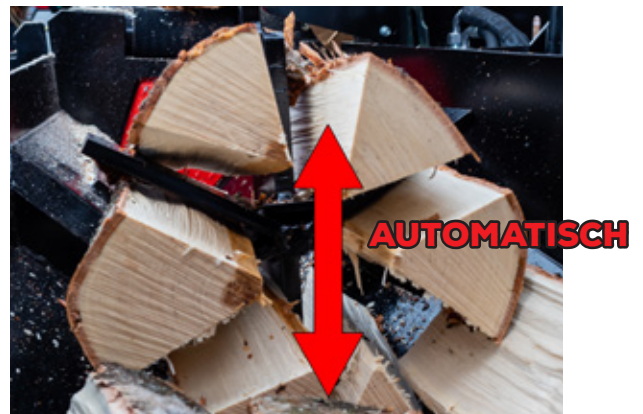
X-Aim stellt das Spaltkreuz automatisch auf die optimale Höhe in der Mitte des Stammes ein.
