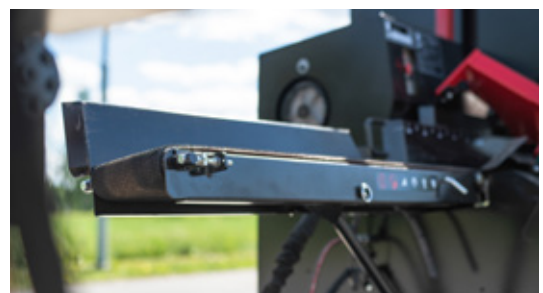
Eine solide Rückwand des Zufuhrförderers erleichtert die Holzzufuhr.
