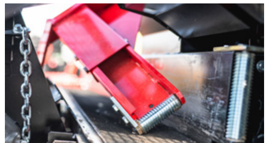
Pro und Pro + Modelle: Die hydraulische Holzlemme arbeitet automatisch und verbessert die Holzsteuerung.
