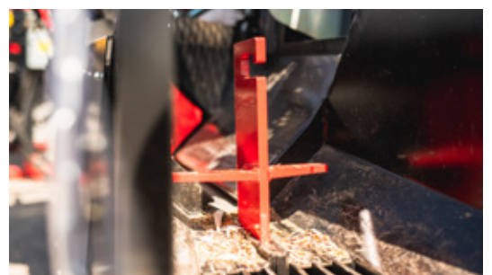
Der einstellbare Spaltkeil ist leicht zu wechseln.
