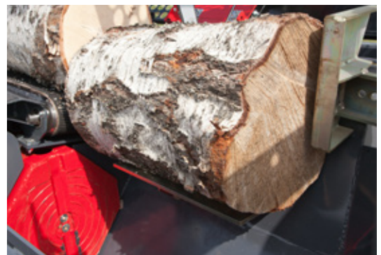
Die Abwurf Platte führt das Holz direkt in den Spaltschacht.
