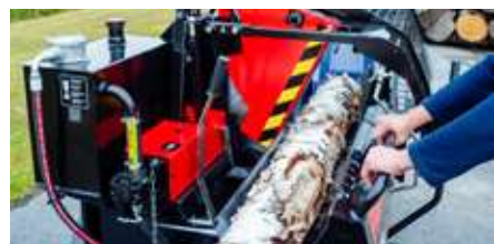
Einfache Stammverarbeitung dank eines stabilen Schneidetisches.
