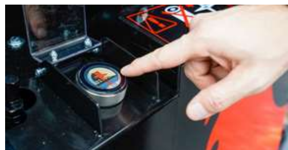
Mit der Intelligenz von X-Aim erhält der Anwender auch Echtzeitdaten zur Arbeitsproduktivität: Der Touch-Encoder unterscheidet verarbeitete Scheite, Betriebsstunden, Anzahl der Zyklen und Sägevorgänge.
